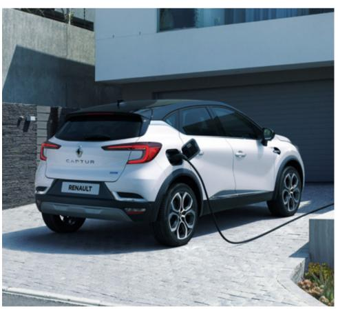
Voll aufgeladen in 6 Stunden an einer Haushaltssteckdose bzw. 3 Stunden an einer Wallbox oder öffentlichen Ladestation.
